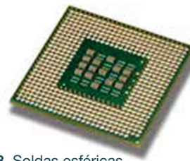
Figura 3. Soldas esféricas Conectadas à parte lateral de um processador
