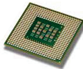
図3. プロセッサの裏面に取り付けられたハンダボール
