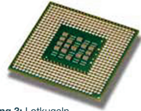
Abbildung 3: Lotkugeln aufgebracht auf die Rückseite eines Prozessors
