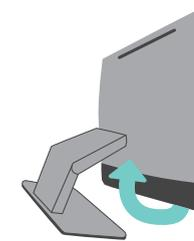
**Der Ständer lässt sich** dank spezieller Schnelleinrastfunktion mit nur einem Tastendruck an der Rückseite des Monitors befestigen.
