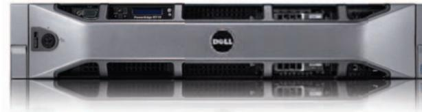
マスターノードとNFSサーバは、48GB (12×4GB)のメモリおよび計算・ノードがNFS経由でアクセスする4TB RAID 5のマスストレージを搭載したDell PowerEdge R710 (2U)です。この高性能なスタンドアロンクラスタを構成するのは、キーボードとマウス付きの格納型1U液晶ディスプレイです。デルによる24インチラックへの完全インストールも含まれます。オペレーティングシステムはLinuxもしくはMicrosoftのクラスタサーバいずれかをお選びいただけます。
