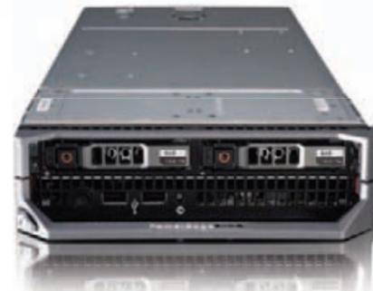
デルの256 (32 ノード) クラスタには、最先端のPowerEdge M610ブレードサーバをベースとしたものがあります。このM1000eシャーシは、32台のM610ブレードで構成され、それぞれのブレードサーバには2.26GHzのCPUクロック速度およびメインメモリ24 GB (6×4GB) のクアッドコア インテル® Xeon® L5520プロセッサ2基が搭載されています。大規模な並列アプリケーションに適したメッセージパッシング機能を円滑にするため、複数の計算・ノードにまたがる並列アプリケーションにはギガビットイーサネットのインターコネクタが備わっています。システム管理用に別途高速のイーサネットネットワークが設定されます。このシステム構成は非常にコンパクトで(20Uシャーシあたり256コア)、最高クラスの消費電力特性があり、外部ケーブルの配線がほとんど必要ありません。
