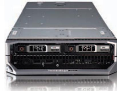
デルの128 (16ノード) クラスタには、デルが最近導入を始めた最先端のPowerEdge M610ブレードサーバをベースとしたものがあります。このM1000eシャーシは、16台のM610ブレードおよびQDR InfiniBandスイッチで構成され、それぞれのブレードサーバには2.26GHzのCPUクロック速度および24GB (6×4GB)のメインメモリ仕様のクアッドコア インテル® Xeon® L5520プロセッサ2基が搭載されています。大規模な並列アプリケーションに適したメッセージパッシング機能を円滑にするため、複数の計算ノードにまたがる並列アプリケーションにはギガビットイーサネットのインターコネクトが備わっています。システム管理用に別途イーサネットネットワークが設定されます。このシステム構成は非常にコンパクトで(10Uシャーシあたり128コア)、最高クラスの消費電力特性があり、外部ケーブルの配線がほとんど必要ありません。
