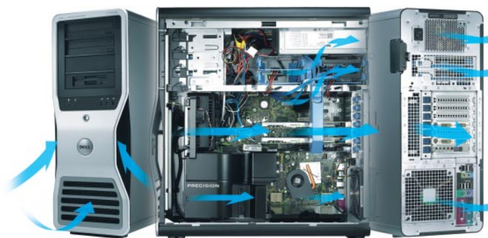
筐体内部と空気の流れ (Dell Precision T7500)
