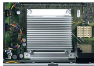
プロセッサ全体の温度を下げながら、動作時の耐熱性を確保するデル独自開発のヒートシンクを採用。
