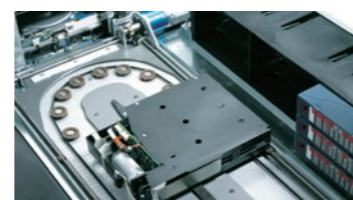
高精度なテープカートリッジ搬送機構
