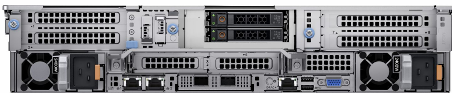
图 10: 带 2x 2.5 英寸存储驱动器、6x PCIe Gen4 插槽和热插拔 BOSS 的 R750 的后视图
