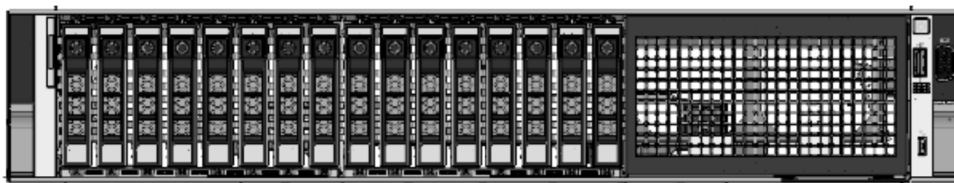
图 4: R750 的前视图, 16x 2.5 英寸 SAS/SATA 机箱
