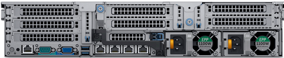
R740 后视图 - 提供 4 个 PCIe 插槽，带有转接卡 2 和转接卡 3 挡片
