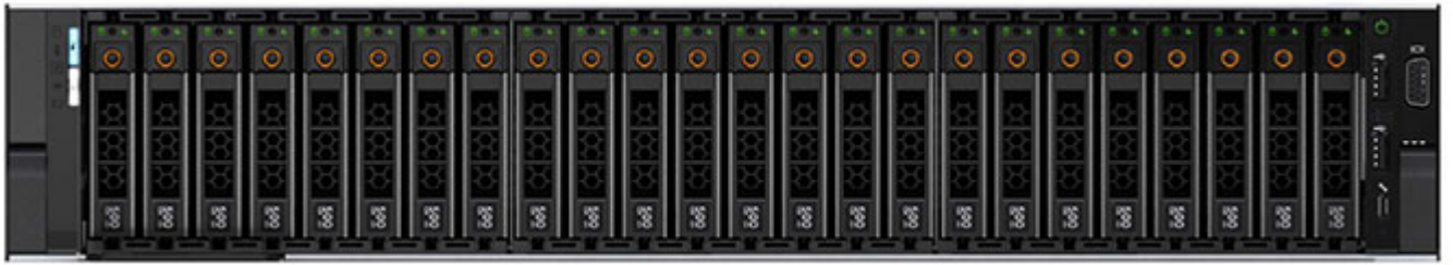
R740xd 前视图 - 24 x 2.5 英寸硬盘配置
