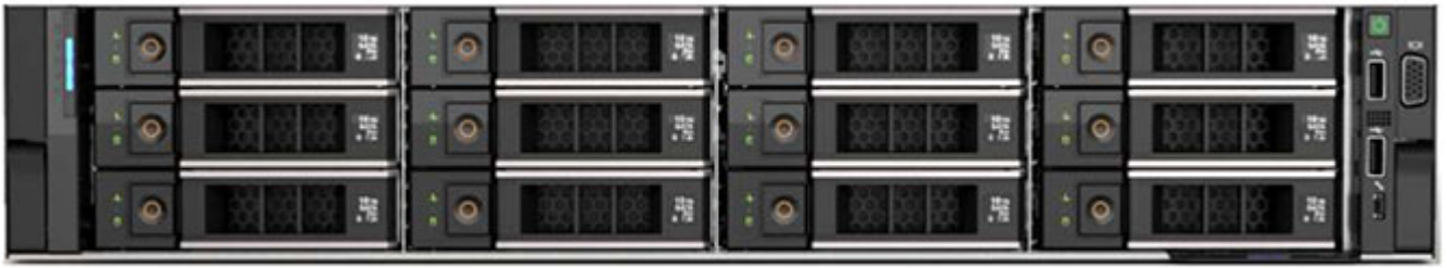
R740xd 前视图 - 24 x 2.5 英寸硬盘配置
