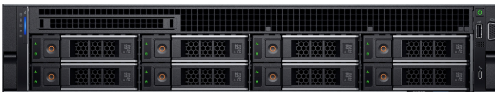
图 1: 8 x 3.5 英寸驱动器系统的前视图
