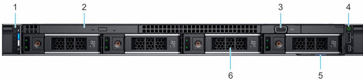
**Figura 1. Visão frontal do sistema com 4 unidades de 3,5 polegadas**
