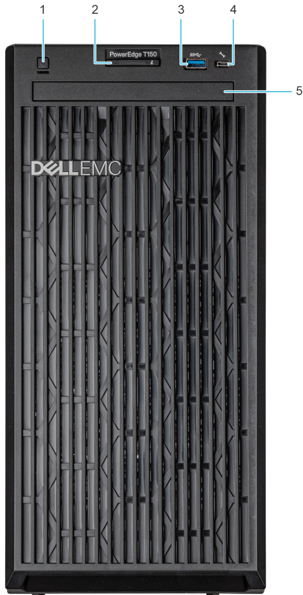
Figura 1. Visão frontal do sistema com 4 unidades de 3,5 polegadas
