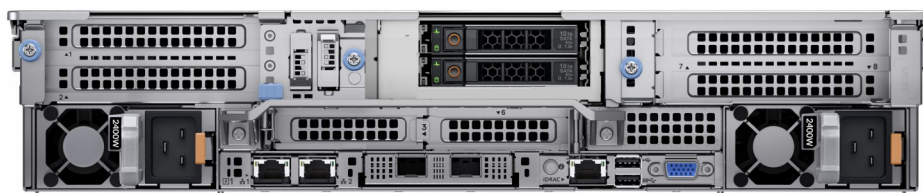
図 10. 2 台の 2.5 インチ ストレージ ドライブ、6 個の PCIe Gen4 スロット、ホットプラグ機能対応 BOSS が取り付けられた R750 の背面図
