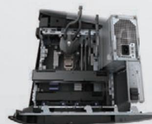
デスクトップでは、より長くマシンを使えるようにツールレスでグラフィックカード、ストレージやメモリーを容易に換装できます。また設置サイズを小さくするため、スイング式の電源ユニットを持ち、緻密にパーツ・配線配置が設計され、高密度実装を実現します。
