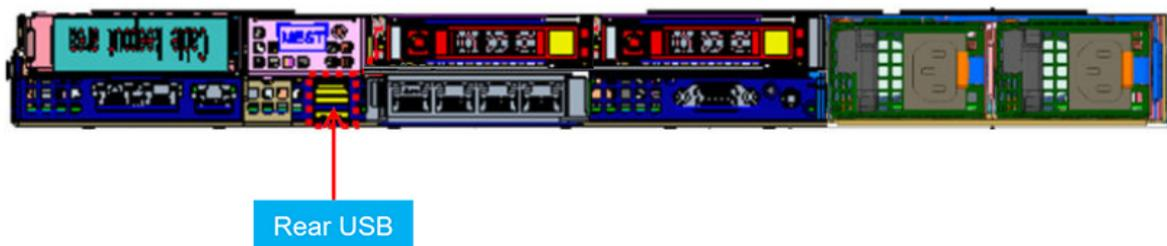
Figura 20. Rear USB (USB posteriore)
