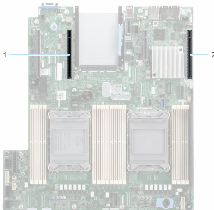
**Figura 7. Connettori dello slot della scheda di espansione**
