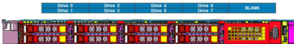
Figure 4. Vue avant du système à 8 disques RAID NVMe de 2,5 pouces
