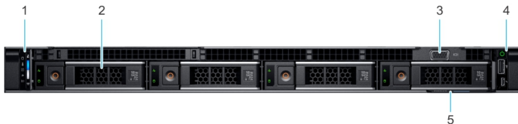
Ilustración 3. Vista frontal del sistema de unidad de 4 x 3,5 pulgadas
