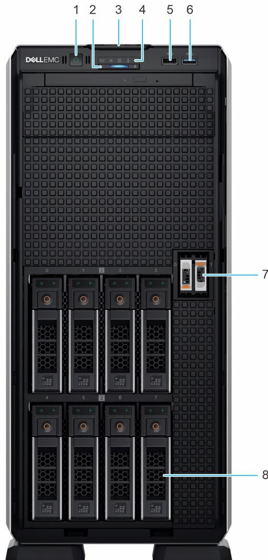
Abbildung 4. Vorderansicht eines Systems mit 8 x 3,5-Zoll-Laufwerksystemen
