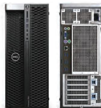
5820 Towerと同じコンパクトな筐体サイズでありながらインテル® Xeon® スケーラブル・プロセッサ・ファミリーを2基まで搭載可能。
