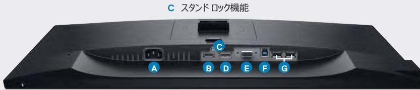
A 電源コネクタ B HDMI ポート E VGA コネクタ G USB ダウンストリーム ポート (x2)
