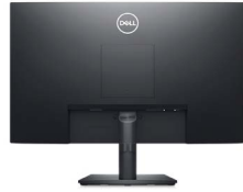
背面図 - ケーブル管理スロット
