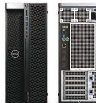
インテル® Xeon® Wプロセッサ・ファミリーを1基搭載できるコンパクトなタワー型モデルです。4チャンネルのメモリアーキテクチャを採用し、最大5本の3.5インチディスクの搭載が可能になり、拡張性が向上しました。また電源ユニットはオプションで950Wを選択可能になり、高性能なグラフィックスの複数搭載に対応しました。
