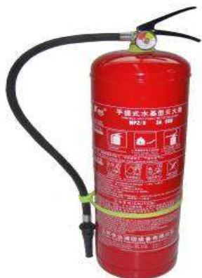
图片 1 水基灭火器 (可使用灭 36KV 下的电气火灾)
