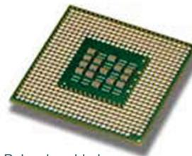
Figura 3. Bolas de soldadura adjuntas a la parte trasera de un procesador
