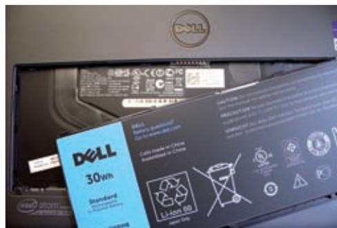
La maintenance du produit est facilitée par les quatre petites vis derrière la batterie amovible qui permettent de déclipser le capot et d'accéder aux composants.
