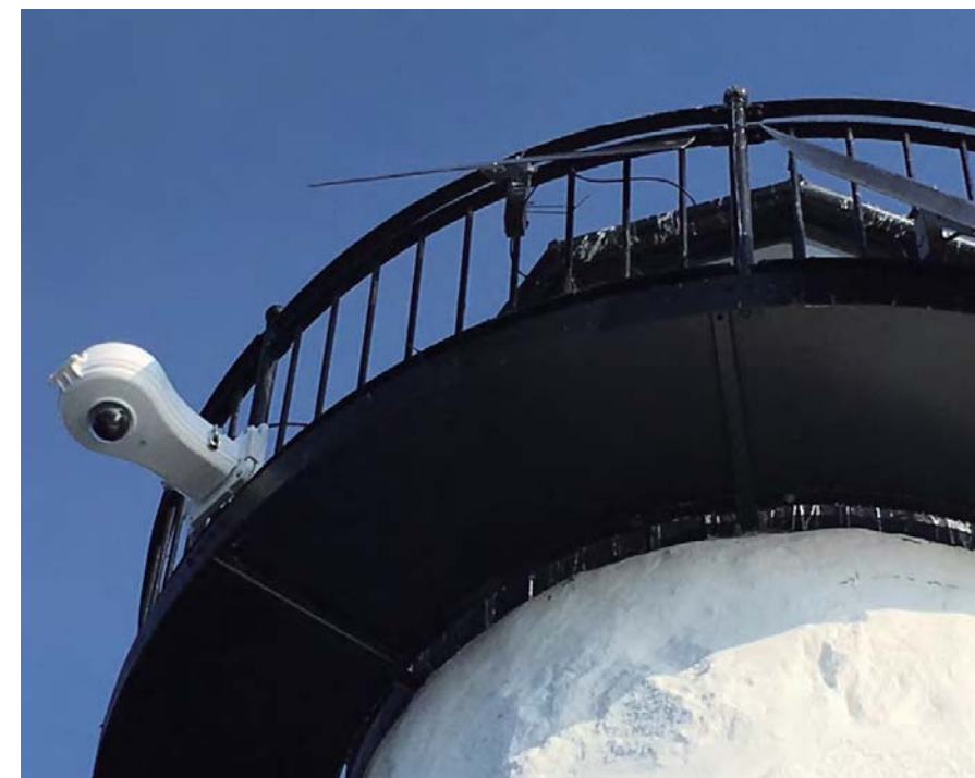
Palmer岛灯塔上的摄像头和具有物联网功能的感应器，为渔屋提供了更多的港口安全数据，并帮助确保船只遵守捕捞配额和港口规章。
