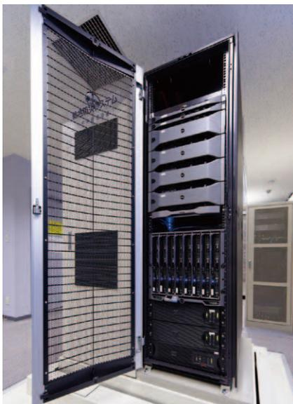
今回導入されたブレードエンクロージャー「PowerEdge M1000e」、ブレードサーバ「PowerEdge M710」、仮想ストレージ「EqualLogic6010XV」。免震構造のフロアに設置されている
